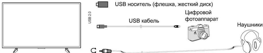
Разъём для подключения USB-устройства телевизора становится активным только в режиме USB.
